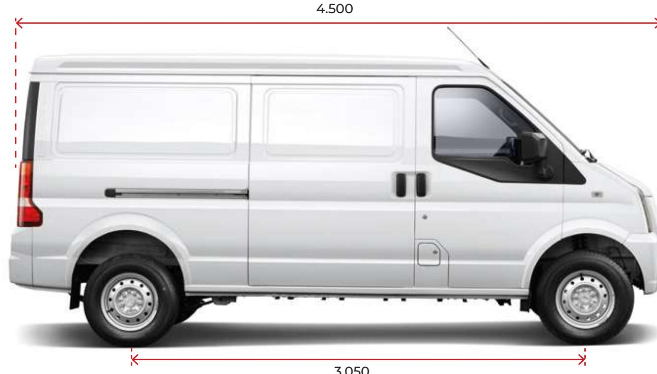
Las dimensiones y el espacio de carga del DFSK EC35 posibilitan muchas aplicaciones distintas. La zona de carga tiene un volumen de 4,8m<sup>3</sup> resultando realmente espacioso, además proporciona una carga útil de 1.090kg.
